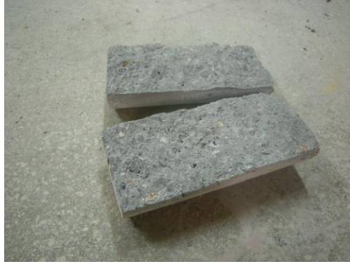
Şekil 8. Silindir yarma deneyinden sonra numunenin görünüşü (Figure 8. Appearance of sample after splitting strength test)
