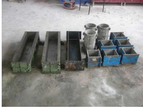
Şekil 3. Beton numune kalıpları (Figure 3. Concrete sample patterns)
