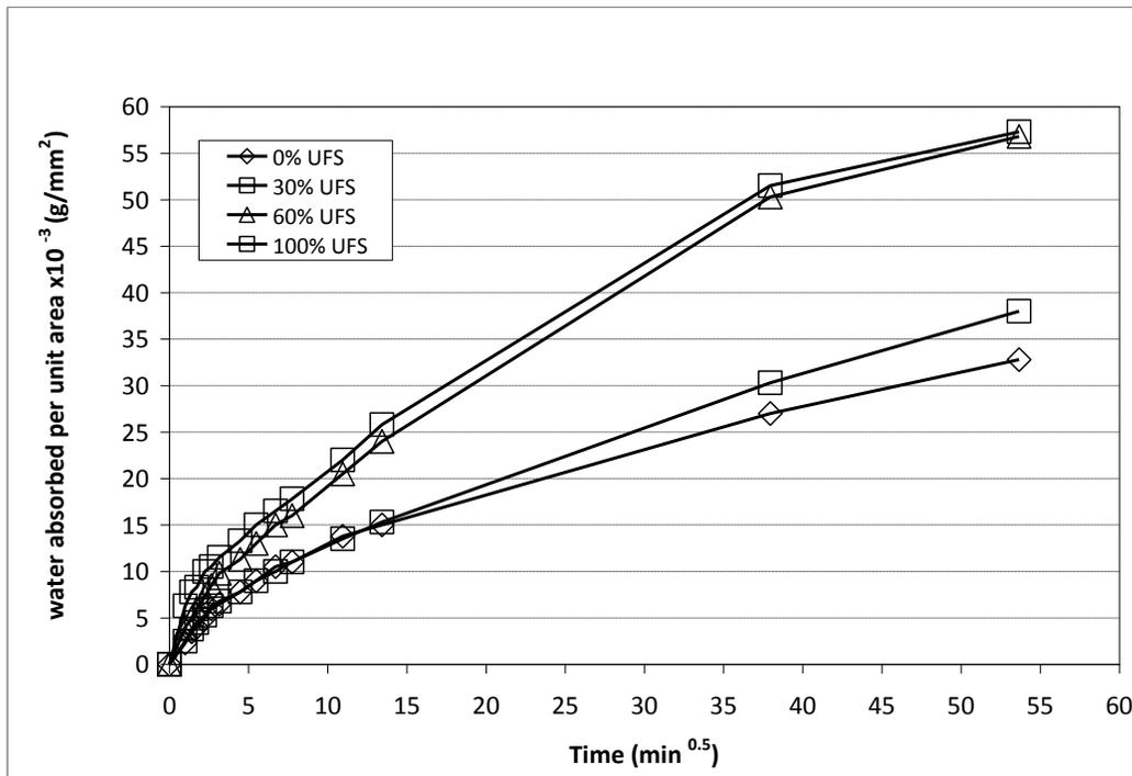
Figure 3. Capillary water absorption of concretes containing varying amounts of foundry sand at 28 days of curing - First 48 hours (Şekil 3. Değişik oranlarda dökümhane kumundan üretilen betonların 28 günlük kürde elde edilen ilk 48 saat için kapiler su emme değerleri)
