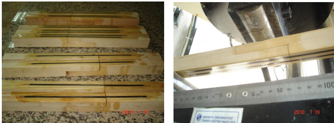
Şekil 5. KTP çubukla güçlendirilmiş tek ve çift çubuklu deney numunesi (Figure 5. Samples of timber connection strength with single and double CFRP bar)
