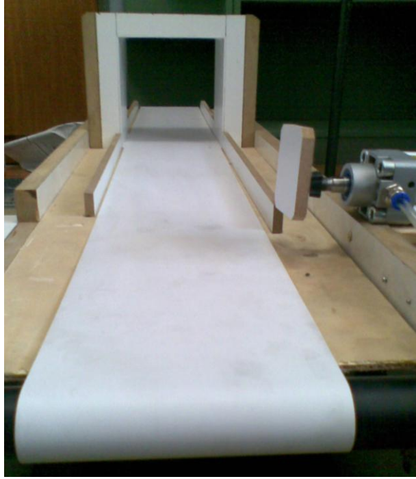
Şekil 6. Tasarlanan sistem ve yürüyen bant sistemi (Figure 6. Designed sistem and belt conveyor system)
