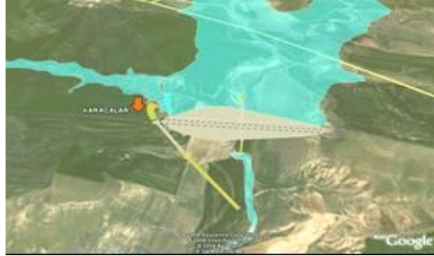
Şekil 4. Karacalar barajı genel vaziyet planı (gövde tipi hardfill) (Figure 4. General layout of the dam Karacalar) (body type hardfill)
