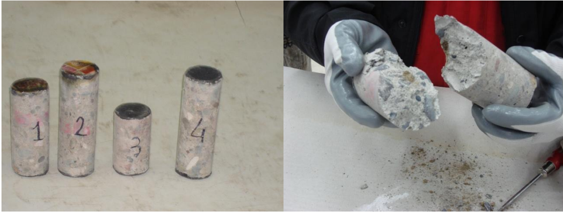
Şekil 2. Karot numuneler ve eksenel yük altında kırılan bir numune (Figure 2. Core samples and a sample fractured under axial load)
