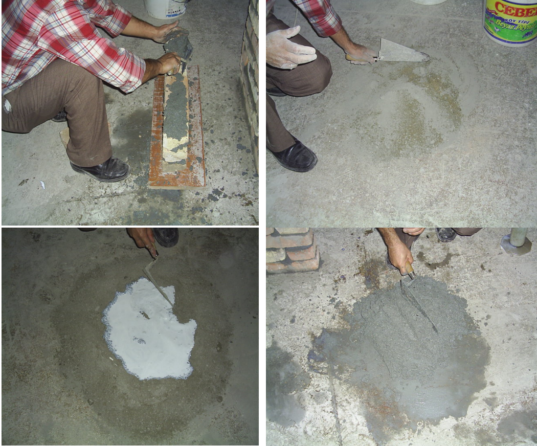
Şekil 2. Numune örülmesinde kullanılacak harcın hazırlanması (Figure 2. Preparation of the mortar to be used in the bonding of the samples)
