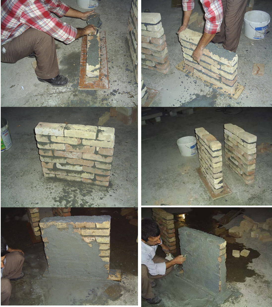
Şekil 3. Deney numunelerinin hazırlanması (Figure 3. Preparation of the samples)
