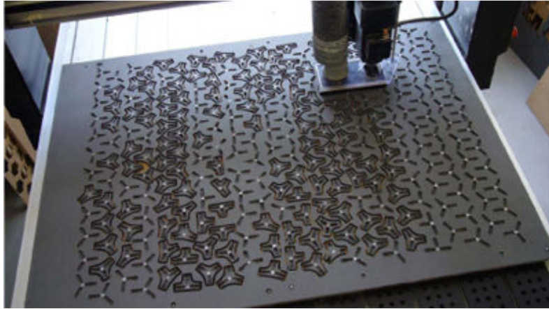
Resim 5. "CNC ile kesim işlemi" [11] (Figure 5. "CNC cutting process") [11]
