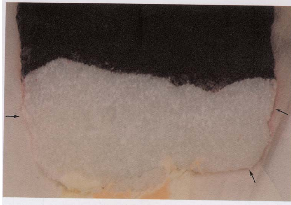
Resim 3: Cam iyonomer siman grubunda 3 deęerinde sızıntı (x 25).
