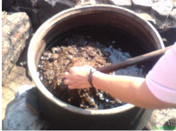
Şekil 1. Boyanmış yün halı ipliklerinin göl çamurunda bekletilmesi (Figure 1. To smear with mud of dyed wool carpet yarns)
