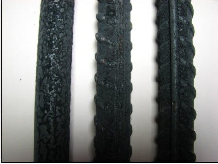
Şekil 3. 1000 °C'ye maruz kalmış donatı numuneleri
