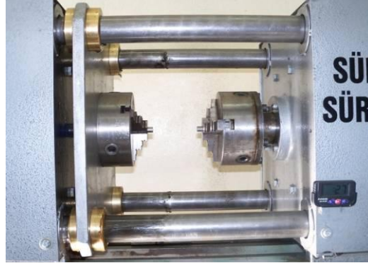
Şekil 3. Dönerli ayna ve eksenel hareketli ayna donanımı (Figure 3. Axially movable chuck and rotating chuck hardware)
