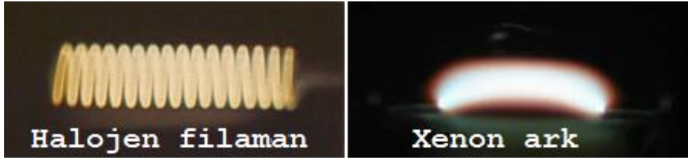
Şekil 1. Halojen filamanı ve xenon arkının görünüşü [21] (Figure 1. The appearance of halogen filament and xenon arc [21])
