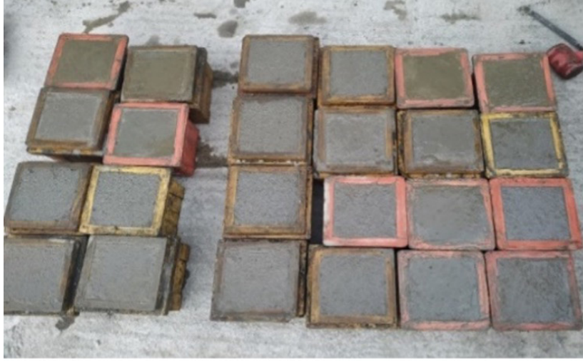
Şekil 2. Kalıplara yerleştirilmiş beton numunesi örnekleri
