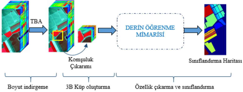
Şekil 8. Hiperspektral görüntü sınıflandırması için çerçeve (Framework for hyperspectral image classification)
