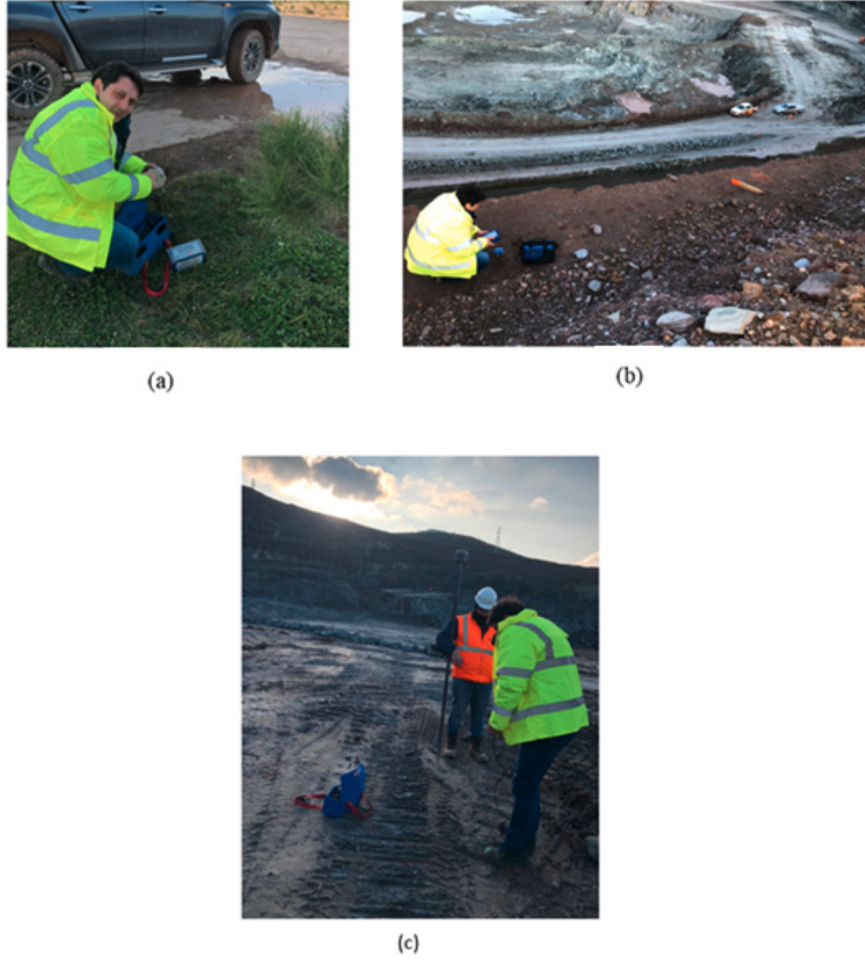
Şekil 3. Titreşim verilerini alacak sismografların yerleştirilmesi, (a) Sismograf-14465, (b) Sismograf Micromate, (c) Sismograf 13638
