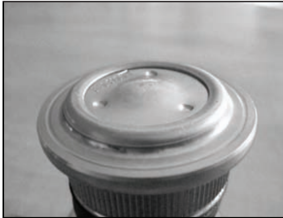
Şekil 8. Başarılı şekilde sıvandırmış küresel yatak.
