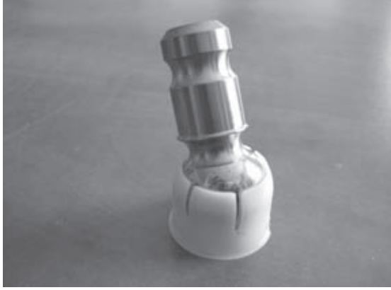
(a) Küresel mafsalları mil ve pom malzeme.
