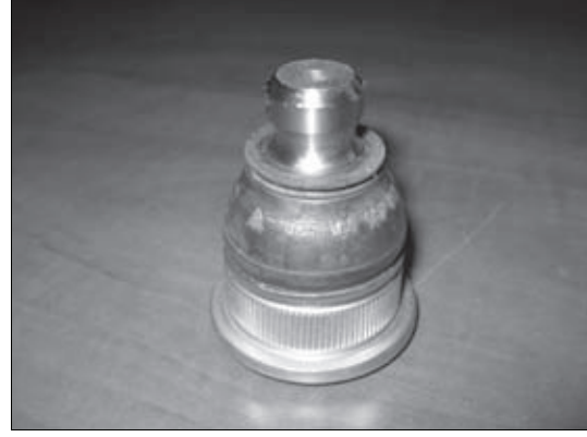
(a) Montajı tamamlanmış rotill.
