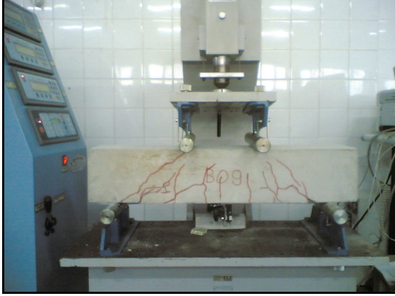
Şekil 3. B09 deney elemanı-kirişte oluşan çatlaklar.
