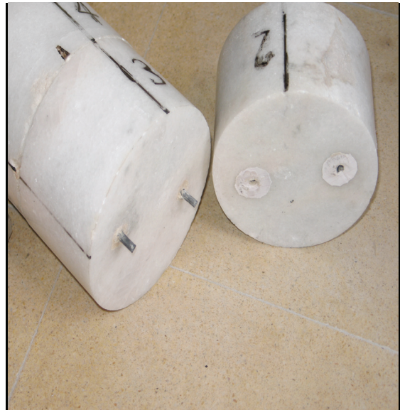
Şekil 5. Deneylerde kullanılan 1/10 ölçekte mermer tambur ve kurşun kenetler.
