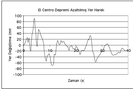
Şekil 6. Tablaya uygulanan El Centro depremi titreşimi.
