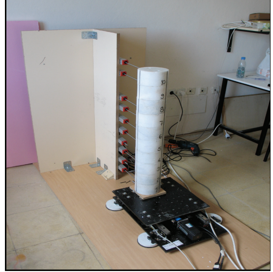
Şekil 8. Deney elemanı sütun, sarsma tablası ve potansiyometrelerin görünümü.
