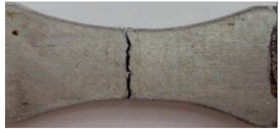
Şekil 9. Esas malzemenin kopma bölgesi.
