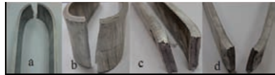
Şekil 14. Eğme deneyleri a) ve b)-Esas malzemedeki c) ve d) kaynak yapılmış numuneler.
