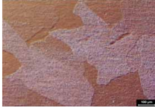
Şekil 4. Atomizasyon öncesi IF çeliğine ait mikroyapı görüntüsü. Yapı saf ferritik tanelerden oluşmaktadır. Nital ile dağlama, ışık mikroskopisi, Faz kontrastı.
