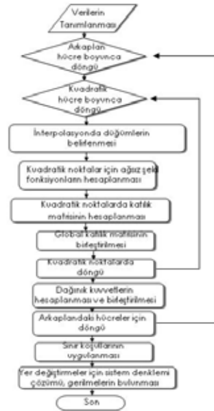
Şekil 11. EBG için program akış şeması.
