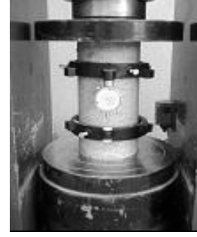
Şekil 2. Gerilme-şekil değiştirme verilerinin alınmasında kullanılan çerçevenin görünümü
