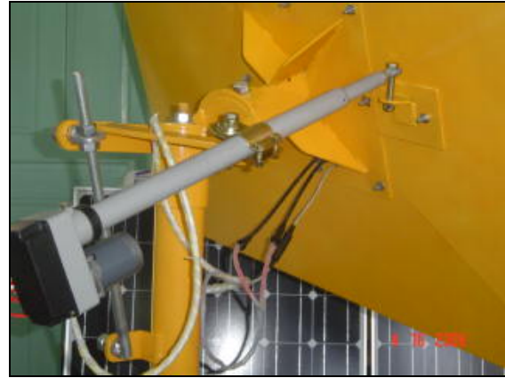
Şekil 8. Güneş takip mekanizmasının arka bağlantıları.
