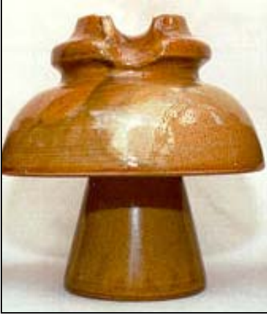
Şekil 6. Hasara uğramış bir porselen izolatör
