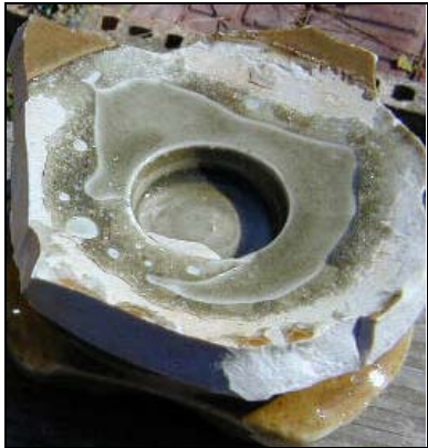
Şekil 8. Alt kısmı hasara uğramış bir porselen izolatör
