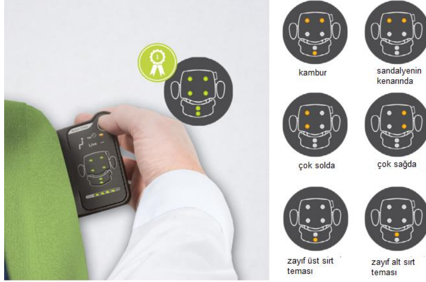
Şekil 13. Axia Akıllı Sandalye çalışma mantığı. GörSELLER [39]'den derlenmiş, metnin yazarı tarafından düzenlenmiştir.
