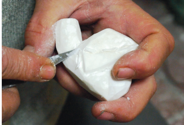
Görsel 7: Üretilecek objeye göre, kabaca biçimlendirilmiş taş
