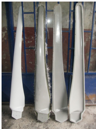
Şekil 7. İmal edilen model ve poliester kalıp yarıları (the made model and polyester stereotypes)
