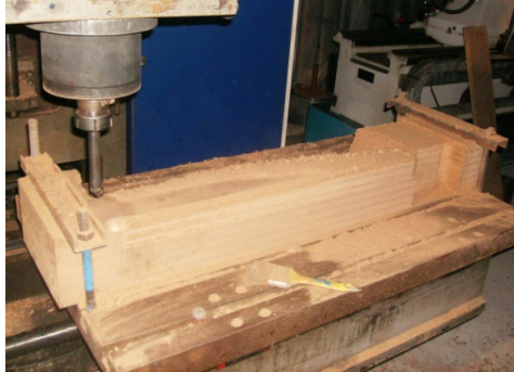
Şekil 6. Hazırlanan bir model kütüğü ve kanat 1. yarısının işlenmesi (Prepared model index and processing of first half of wing)
