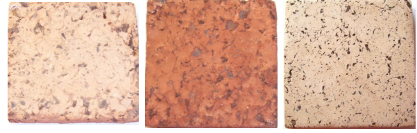
Şamotlu Çamur Kırmızı Çamur Akçini Çamuru Şekil 4: %50 Arduvaz katkılı agrega bünyeler (%50 Slate usage to form an aggregate body)
