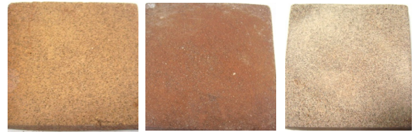
Şamotlu Çamur Kırmızı Çamur Akçini Çamuru Şekil 6: %50 Kum taşı katkılı agrega bünyeler (%50 Sandstone usage to form an aggregate body)
