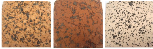
Şamotlu Çamur Kırmızı Çamur Akçini Çamuru Şekil 2: %50 Bazalt katkılı agrega bünyeler (%50 Basalt usage to form an aggregate body)
