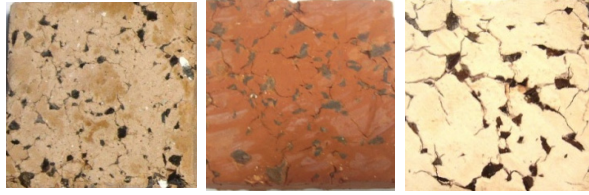
Şamotlu Çamur Kırmızı Çamur Akçini Çamuru Şekil 1: %35 Bazalt katkılı agrega bünyeler (%35 Basalt usage to form an aggregate body)
