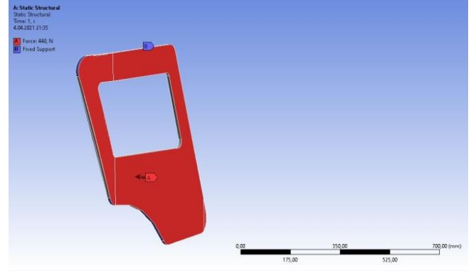
Şekil 22. Kapı tasarımı sonlu elemanlar analizi yük dağılımı
