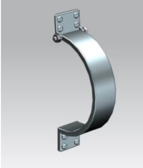
Şekil 26. Kapı bağlantı birimi montaj modeli
