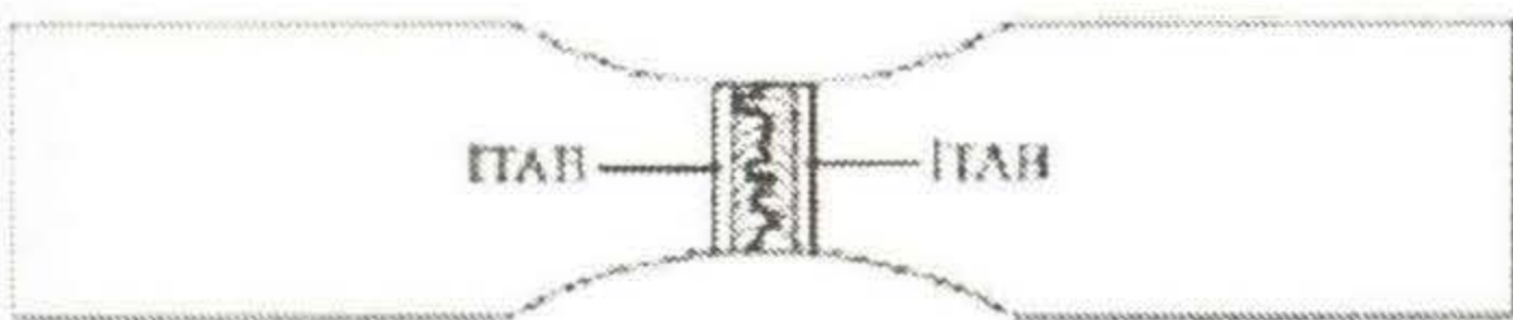
Şekil 8. Kaynaklı malzemeden çıkarılan eğmeli yorulma deneyi numunesinin kopmuş hali
