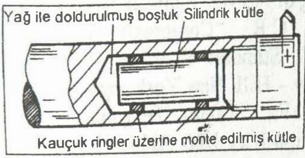
Şekil 14. Bir delik büyültme katerindeki titreşimin sönümlemesi
