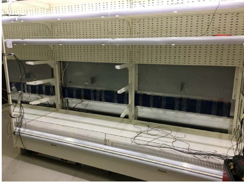
Şekil 4. ADSTD içerisine FDM kaplarının yerleşimi (Placements of PCM packets in the OVRDC)
