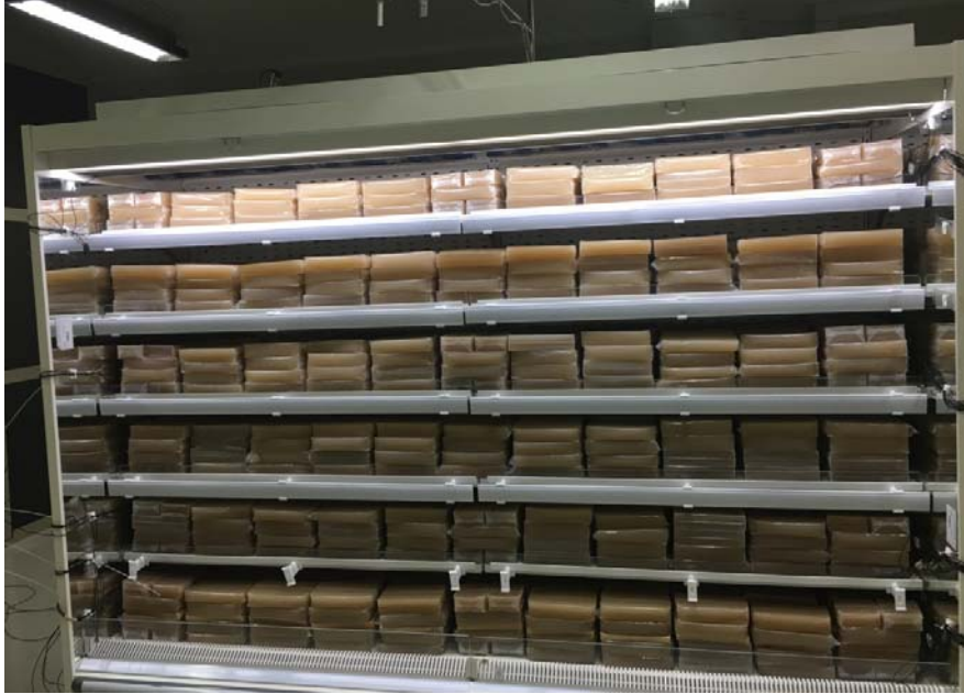
Şekil 3. Kabin içine yerleştirilmiş M paketler TS EN ISO 23953-2 Standartlarına göre test düzeneği (M package placed cabinet test setup according to TS EN ISO 23953-2 Standards)
