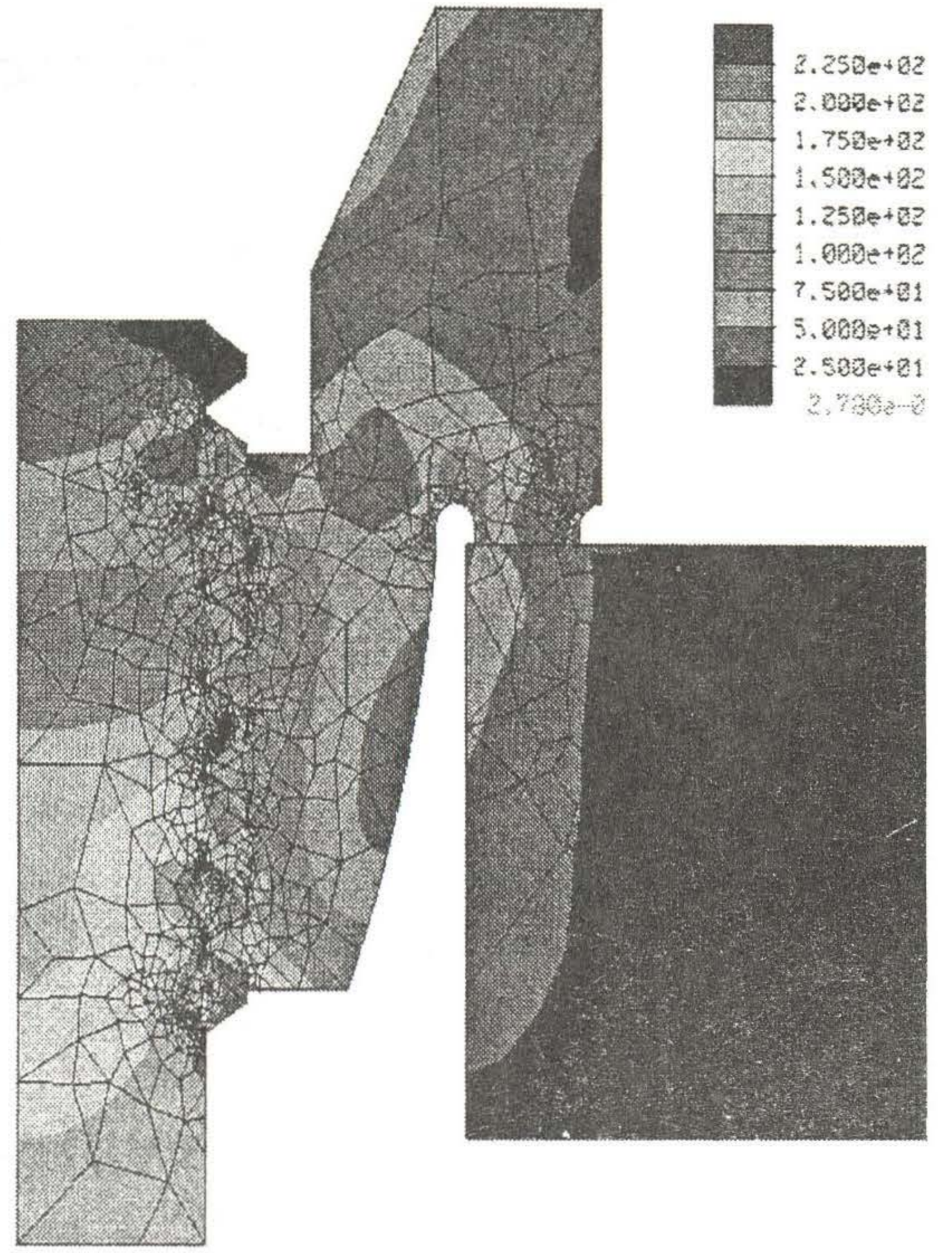
Şekil 9: Somun-2'de 0-225 N/mm 2 arası Von Misses gerilme dağılımı
