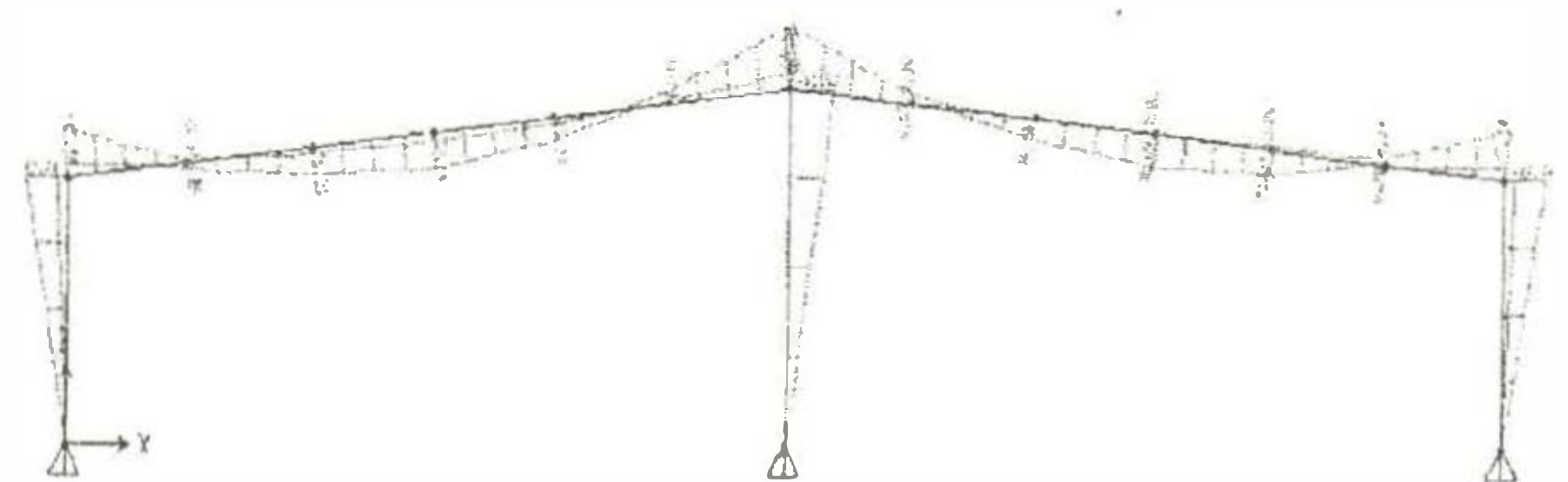
Şekil 1. Sistem 2 için maksimum yükleme kombinasyonu altında oluşan moment diyagramı
