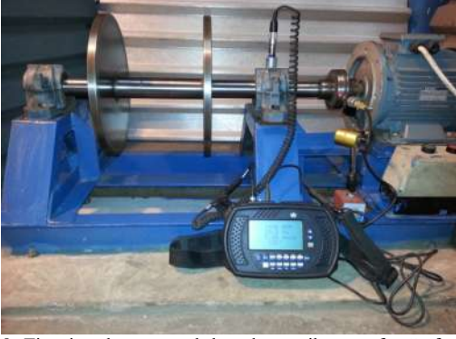
Şekil 8. Titreşim ölçümü yapılırken deney cihazının fotoğrafı (Photo graph of experimental setup while vibration measures)
