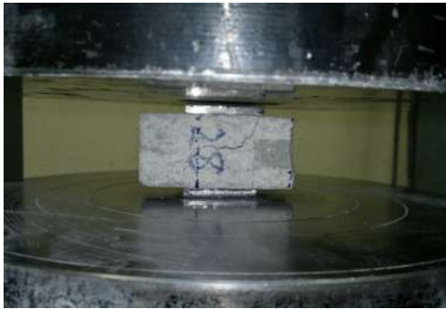
Şekil 7. Basınç dayanımı deneyi (Compressive strength test)
