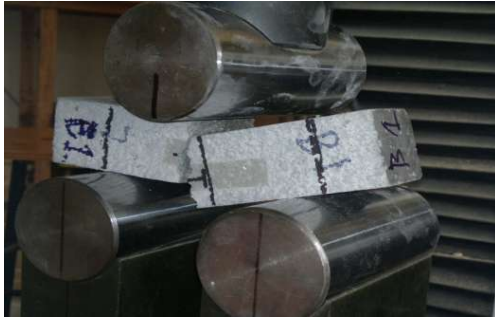
Şekil 6. Eğilmede çekme dayanımı deneyi (Flexural strength test)
