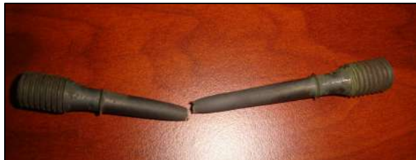
Şekil 3. Sürünme kopma testi sonrası, kopmuş numune(Ruptured specimen after creep rupture test)
