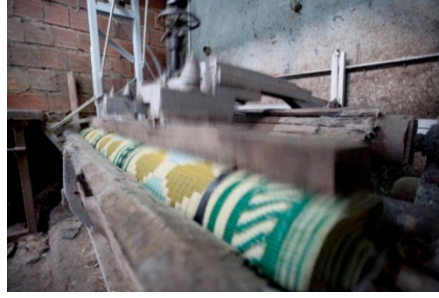
Şekil 8. Keçe tepme makinesinde keçenin tepilme işlemi (Çeliker, 2011)
