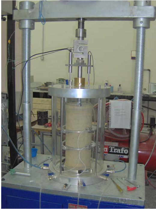
Şekil 3.5. Deney cihazının yüklem çerçevesi ve hücre içerisindeki numune
