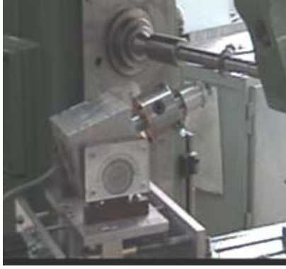
Şekil 5. Konik Helis dişlinin imalatı (9)
