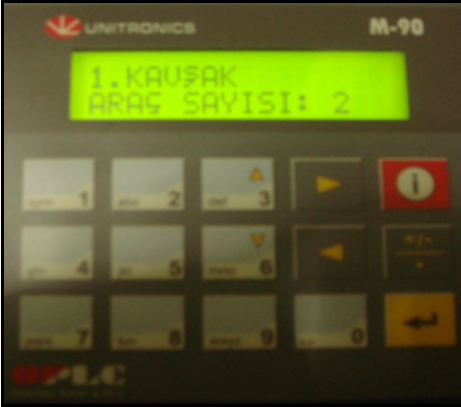
Şekil 13. PLC üzerinde araç sayısının gösterilmesi
