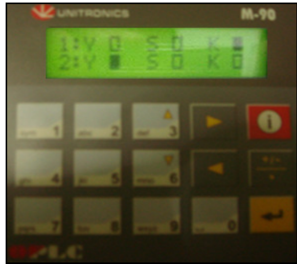
Şekil 9. Sistem çalışır durumdayken PLC üzerinde trafik ışıklarının yanma durumları (1: Birinci yol, 2: İkinci yol, Y: Yeşil, S: Sarı ve K: Kırmızı)
