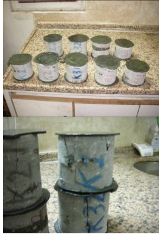
Şekil 2. Kiriş numunesine uygulanan kuru karışım püskürtme betona ait karot numunelerinin görünümü (Çakıroğlu, 2007)
