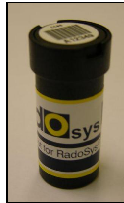
Şekil 1. İçerisinde CR-39 nükleer iz dedektörünün bulunduğu difüzyon kabı
