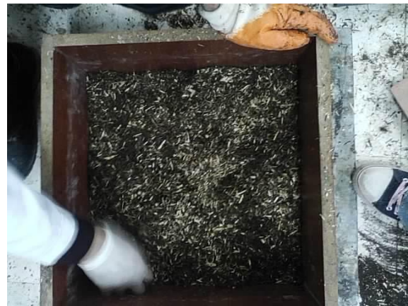
Şekil 2. Levha taslağının hazırlanması
