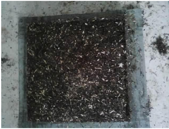
Şekil 1. Soğuk preste işlemi yapılmış yonga levha taslağı
