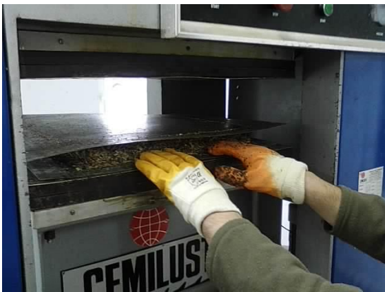
Şekil 2. Yonga levha taslağının hidrolik sıcak preste preslenme aşaması
