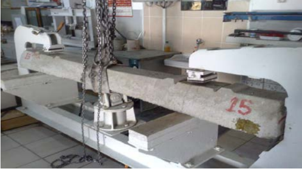
Resim 1. Beton Travers numunesine eğilme deneyi uygulanması
