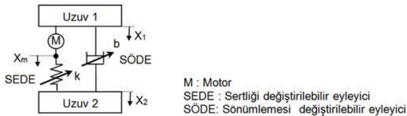
Şekil 1. Biyomimetik eklemlerde kullanılan karma eyleyiciye ait fiziksel model
