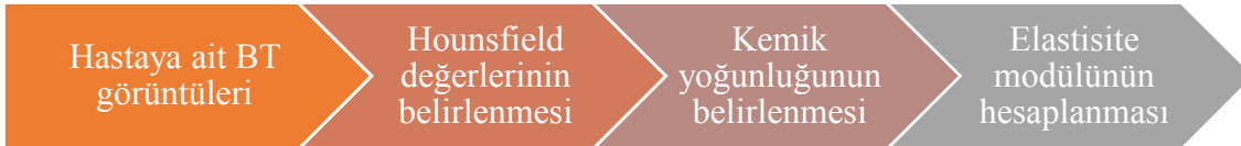
Şekil 2. BT görüntüsünden elastisite modülünün elde edilme aşamaları
