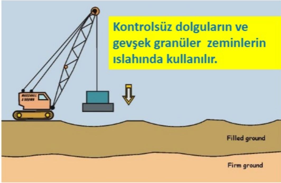
Şekil 11. Derin Kompaksiyon Uygulama Gösterimi (Zemin İyileştirme Yöntemleri 1., n.d.)
