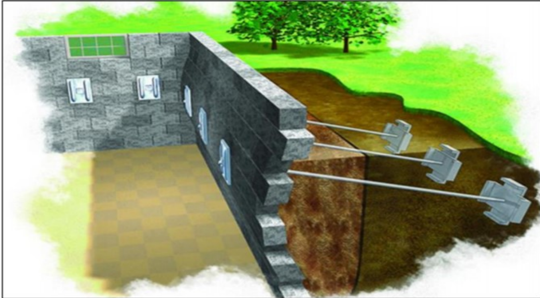
Şekil 7. Zemin Ankrajları Uygulama Gösterimi (Yünkül, 2019)
