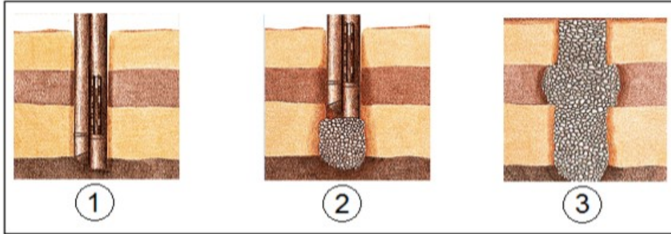
Şekil 2. Taş Kolon Uygulama Gösterimleri (Doğan, 2014)
