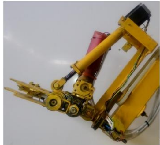
Figure 6. Mounting gripper on robot body Şekil 6. Robot gövdesi üzerinde tutucu montajı
